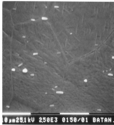
Gambar 8. Struktur martensit hasil penuaan 700 °C
