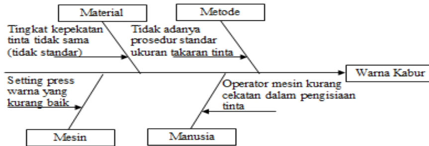
Gambar 3. Fishbone Diagram untuk Defect Warna Kabur
