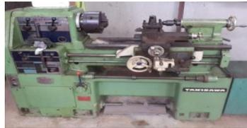
Gambar 1. Mesin Bubut / Turnings
